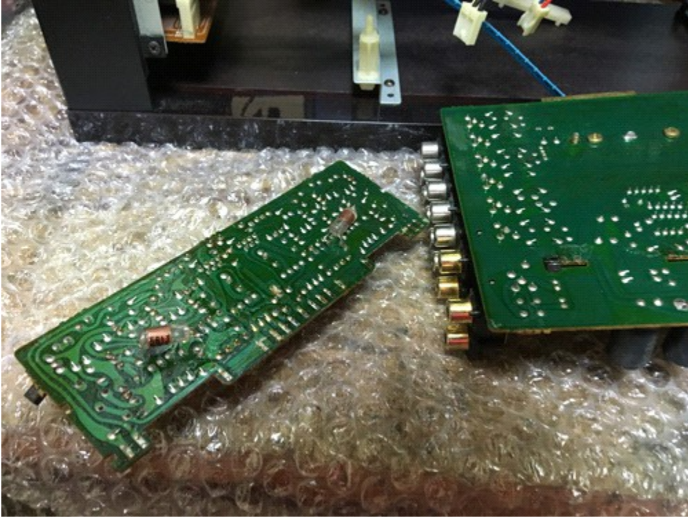
フォノイコライザー基盤の劣化コンデンサー交換、はんだクラックの修理
