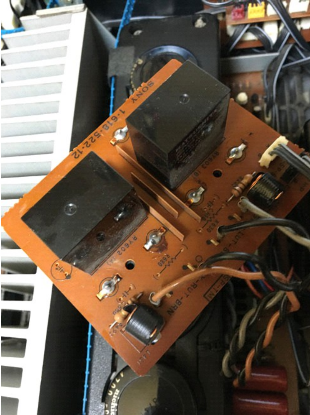
スピーカーリレーの取り外し中
