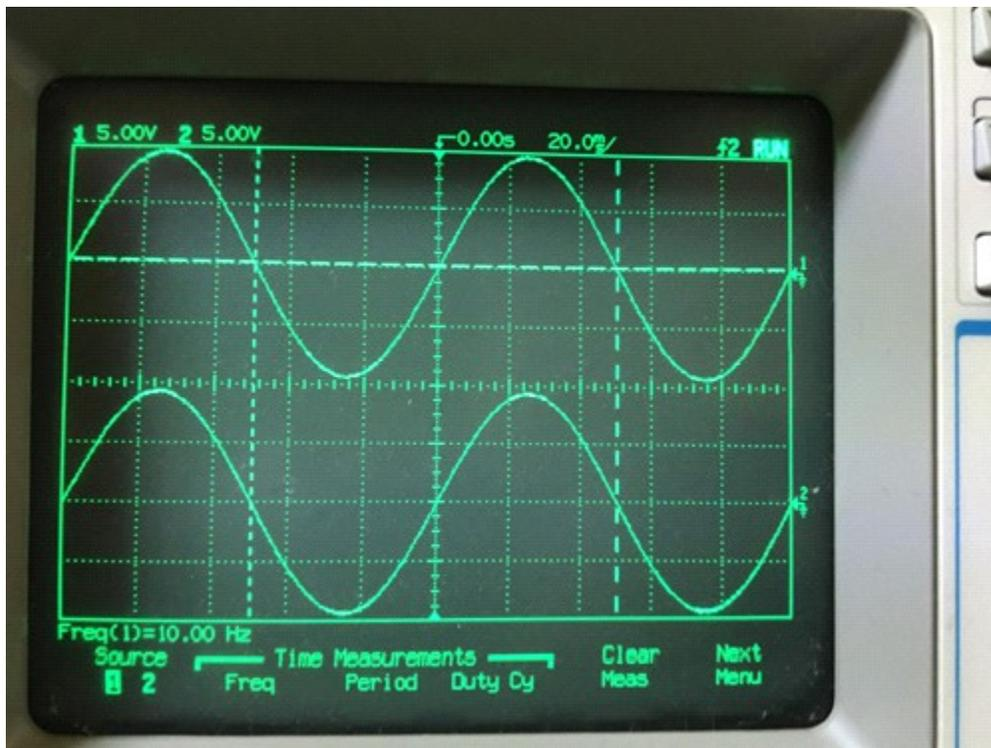
低音側フィルター確認。7.5Hzで0 dBに合わせる（15Hz-18dBオクターブの確認）音では確認出来ないのです。
