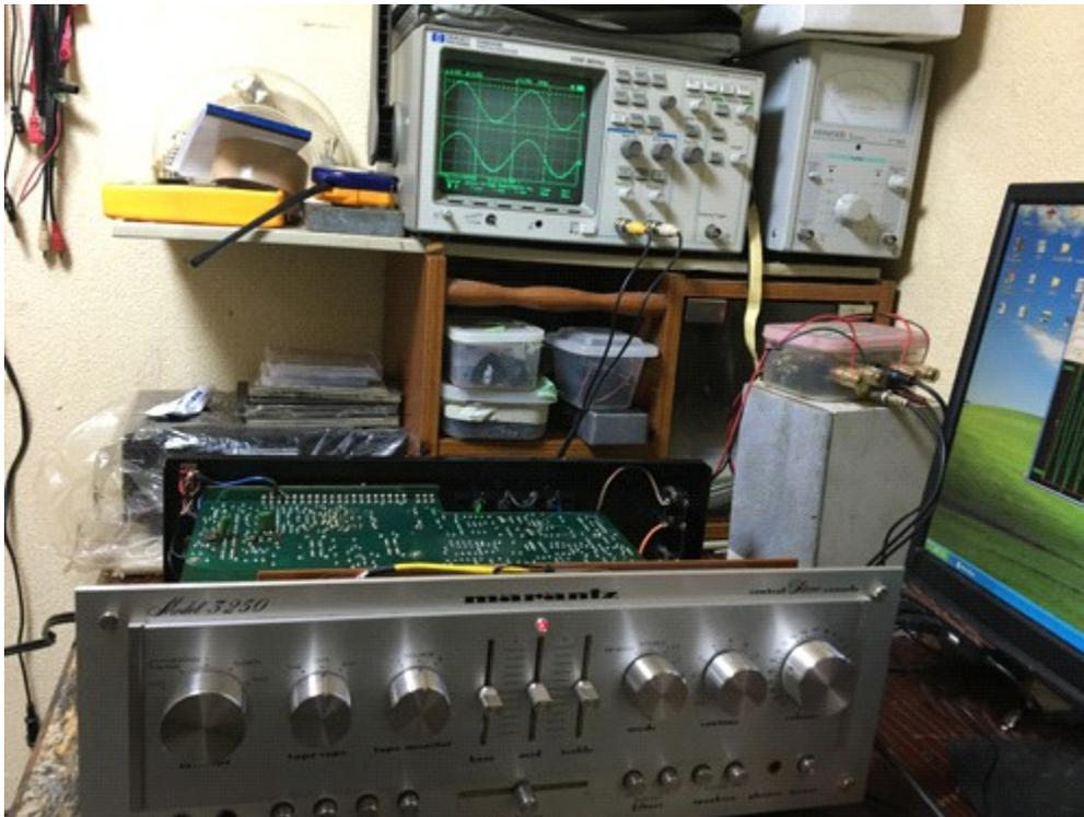
プリアウト最大出力確認 (負荷10K $\Omega$ ) 1KH z
