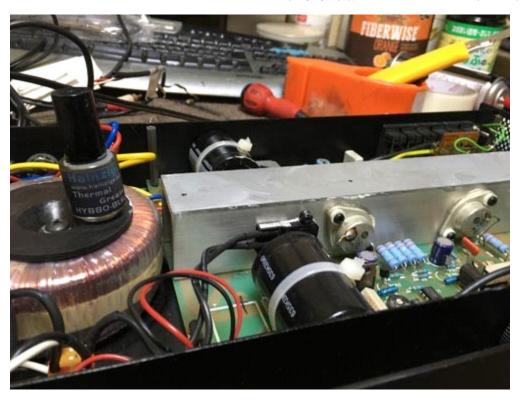
交換部品(フォノ段 MM/MC切り替え回路のバッファ、フォノ電源コンデンサー、メインブロックコンデンサー)
