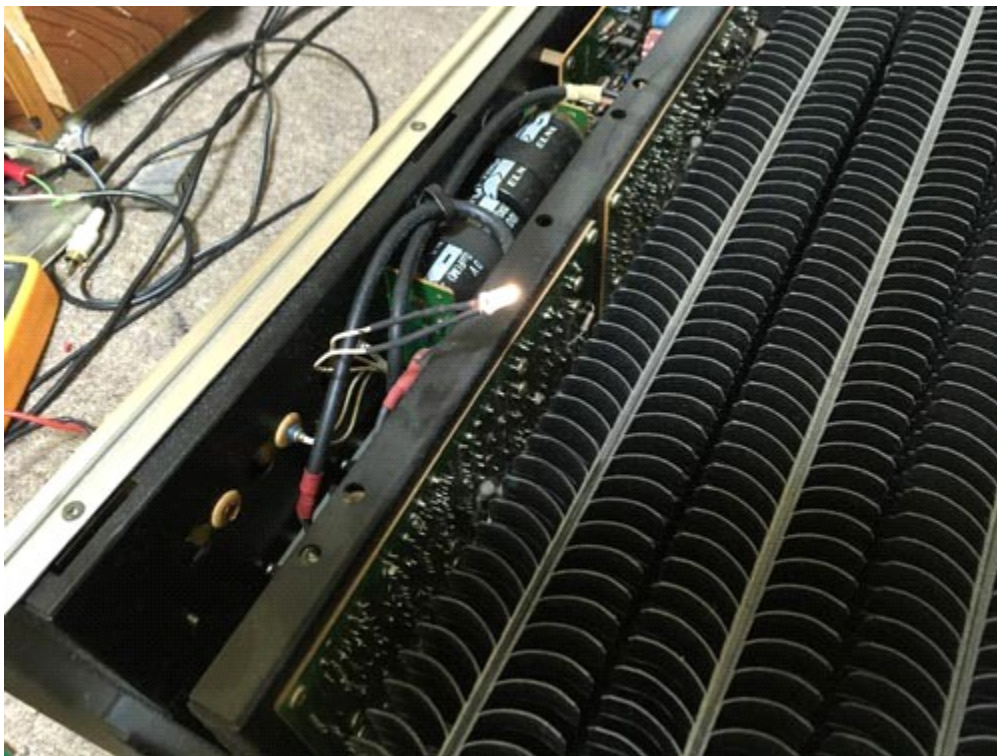
クラスA/AB級ランプ、スピーカーOFFランプのLED化（ランプ切れのため）
