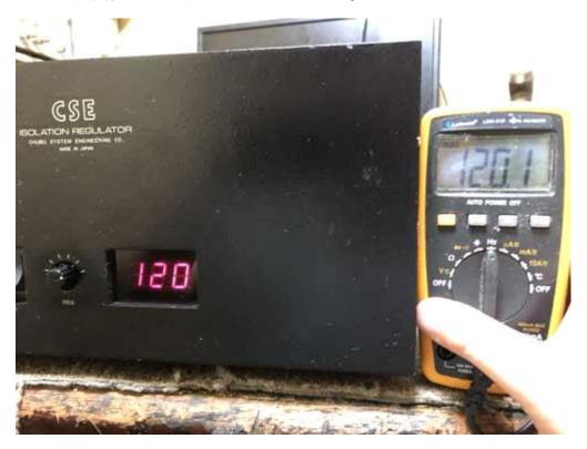
最大負荷テスト (400W 60Hz ダミーロードが無いので400Wの電気ストーブで試験)
