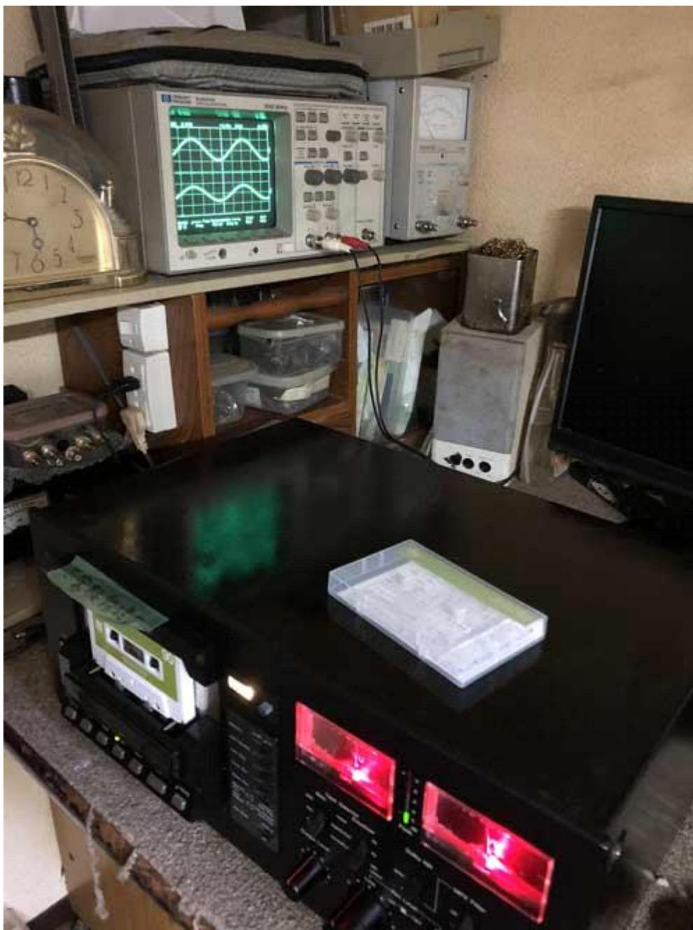
テープ再生波形 1KHz 回転が不安定ならば波形は崩れる
