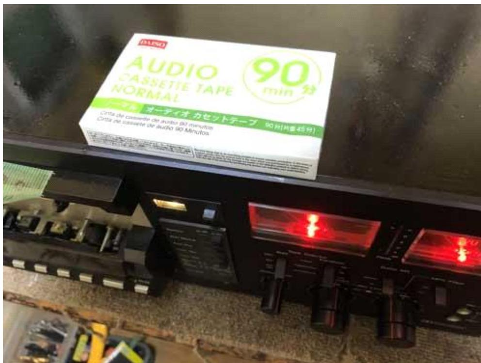
1KHz 正弦波0dB入力を録音し異常が出るか確認をする
